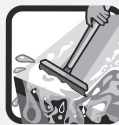
NÃO DEIXE ÁGUA ACUMULADA SOBRE A LAJE
