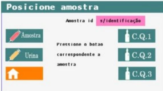
Ao clicar em “s/ identificação” é possível registrar a identificação da amostra utilizando números (três casas decimais). Quando a amostra estiver posicionada na agulha, será sugada ao pressionar o ícone “Amostra”. A amostra deve ser retirada e a agulha deve ser abaixada após um alerta sonoro.
